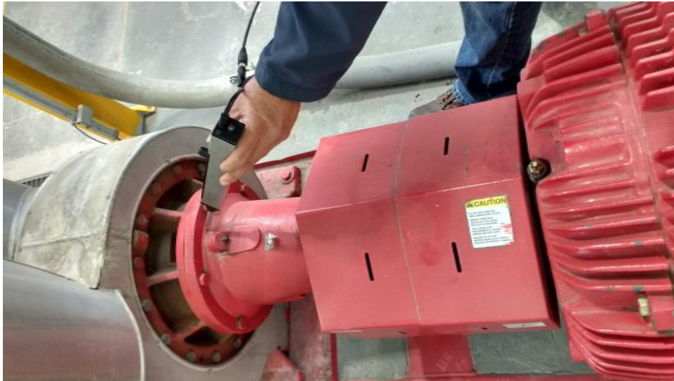
Figura 2: Al tocar la carcasa de un activo el detector de Ultrasonido UL101 es capaz de recolectar la energía acústica transmitida por la estructura, misma que puede ser representada de manera gráfica para obtener información sobre la salud del componente sujeto a prueba.
